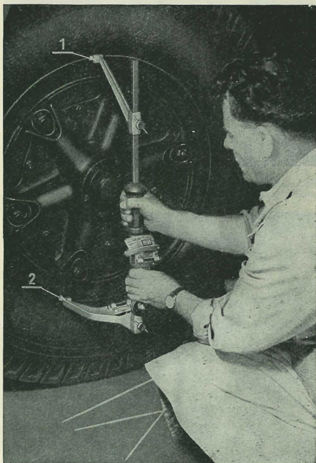
Obr. 133. Měřidlo v základním postavení při zjišťování příklonu čepu (kola v pravém reždu) 1 — 2 — rysky na ráfku
