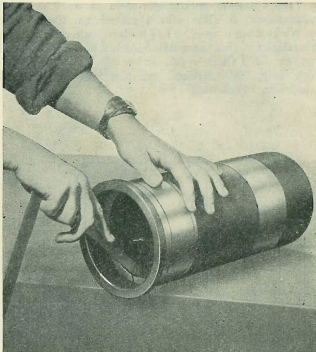
Obr. 36. Kontrola vůle zámku kroužku →
